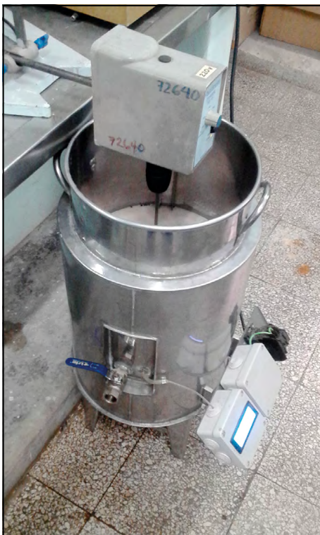
Figura 3. Equipo de maceración empleado en la prueba a escala de banco.
